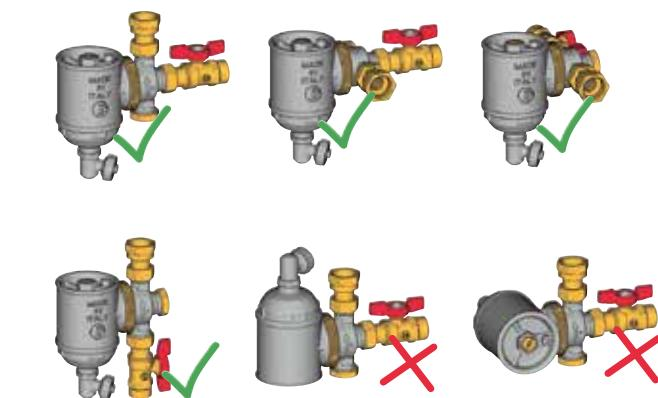
Очистку сепаратора можно производить не разбирай его и\или не отключая систему. Для этого необходимо открыть сливной кран и извлечь магнит из корпуса.
