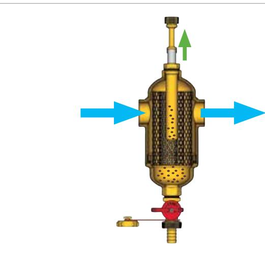
Подождать несколько минут, затем открыть сливной кран, поворачивая его против часовой стрелки и слить жидкость в специально подготовленную емкость.
