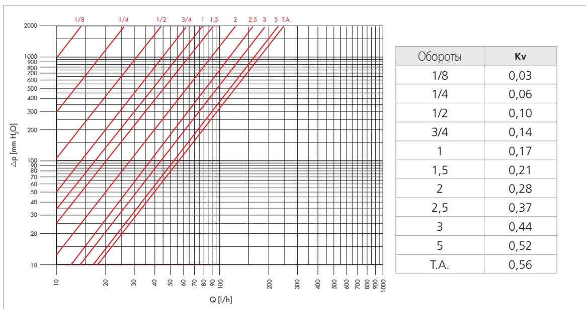
Краевые условия диаграммы и величины кривой: обратный клапан открыт пропорционально при  $\Delta T=2$  с помощью головки термостата и дистанционного управления R463.
