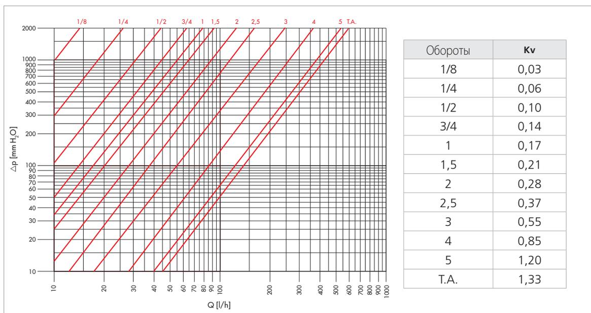
Краевые условия диаграммы и величины кривой: обратный клапан полностью открыт с помощью регулируемого вручную колпачка и электротермической головки R473/ R478.
