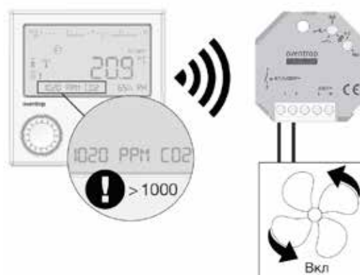
Взаимодействие термостата „R-Tronic“ с преобразователем сигнала „R-Con 2P“
